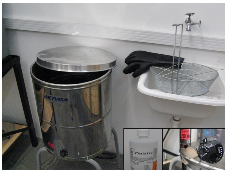
Figura 6. Equipamento utilizado para banho de soda cáustica nos modelos de prototipagem rápida.
